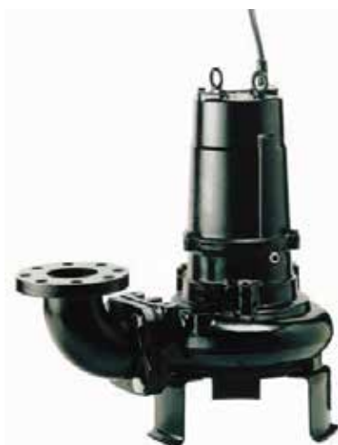
Turbine vortex - grands intérieurs de corps de pompe - moteur à 4 pôles - imbouchable
